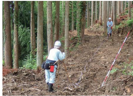
現地検査でポケットコンパスを据え付け
